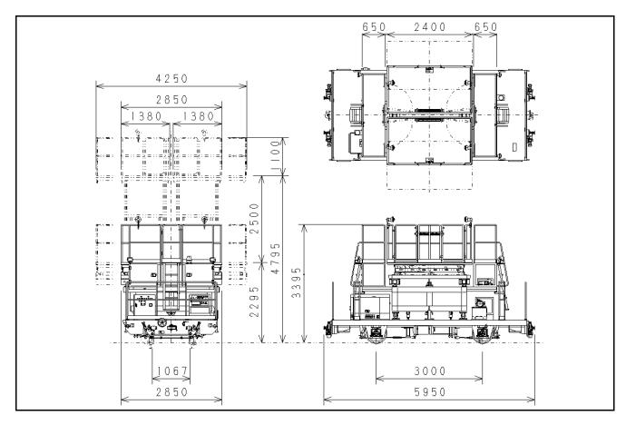
長2.4m×幅1.38mの昇降作業台を2台装備しており、左右独立して操作が可能です。 カントのある軌道上でも作業台は水平な状態での使用が可能です。 作業台は、高さ4,725mm(レール面~作業台床面)まで上昇します。 操作リモコンを差し換えることで作業台の下からも昇降・張出操作が可能になります。
