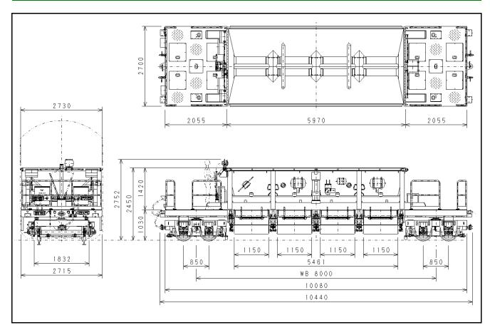
軌間内・軌間外に砕石の散布が可能で、スピーディーな補充作業に最適です。 油圧シリンダーによるシャッター開閉機構により確実に砕石をストップさせます。 オプションとして遠隔運転室を装備することも可能です。(MC422型) 防音構造により、砕石の積み込み作業・散布作業の環境が改善されます。 軌間内・軌間外の切換操作は、手動レバーの操作で安全な切り換えが可能です。
