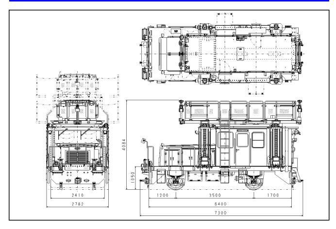
屋根上に油圧式の作業台を装備し、架線の張替や点検に活躍します。 定低速油圧駆動方式により一定速度での走行が可能です。 接地用パンタグラフにより、架線の残留電圧をレールに落とすことができます。
