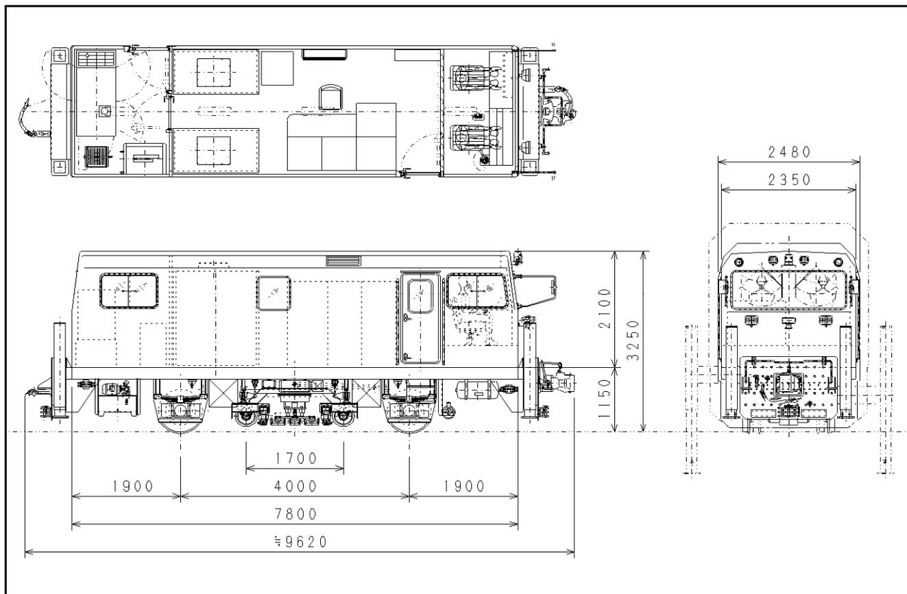
モーターカーの牽引又は推進により、40km/hでの連続探傷が可能です。
