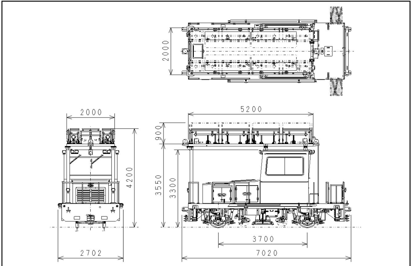
長5.2m×幅2.0mの大型の固定作業台を搭載し、トンネルや架線の点検に活躍します。
